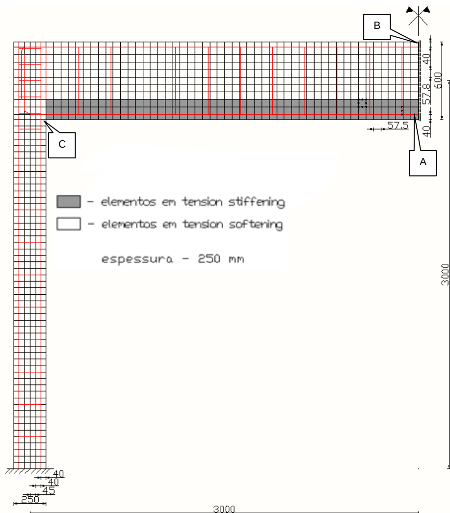
Fig. 5.15 - Malha de elementos finitos utilizada (as dimensões estão em mm)
