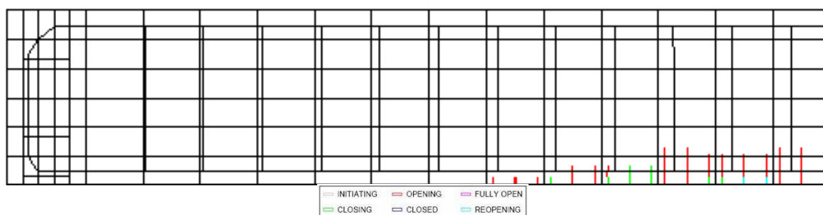
Fig. 5.9 - Padrão de fendilhação antes da quebra de rigidez (ponto B da figura 5.4)
