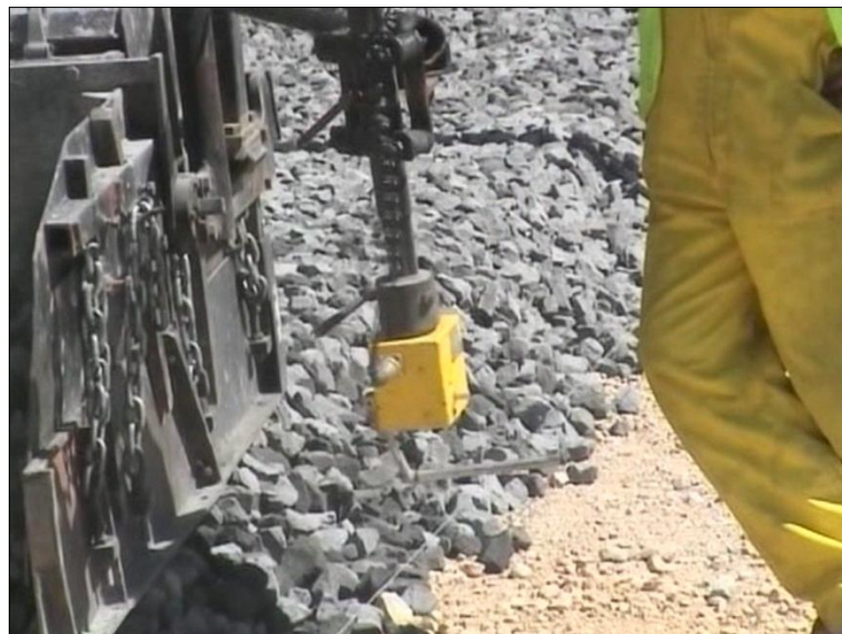
Fig. 3.11 – Sensor de controlo do movimento da espalhadora [7]
