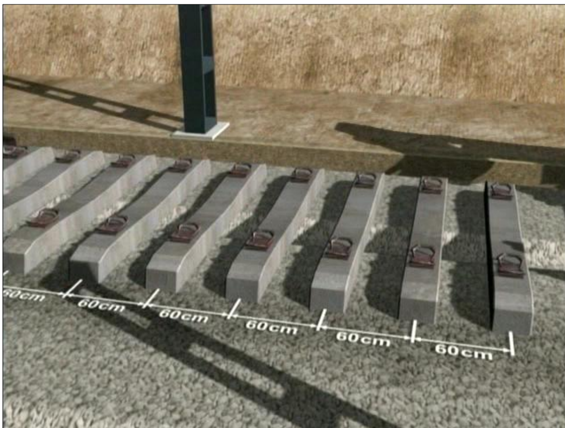
Fig. 3.12 – Espaçamento das travessas [7]
