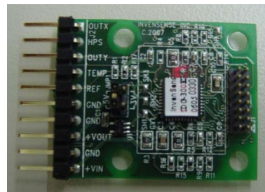
Figura 5.15 - Módulo de giroscópios da InvenSense , inserido numa placa de circuito impresso.
