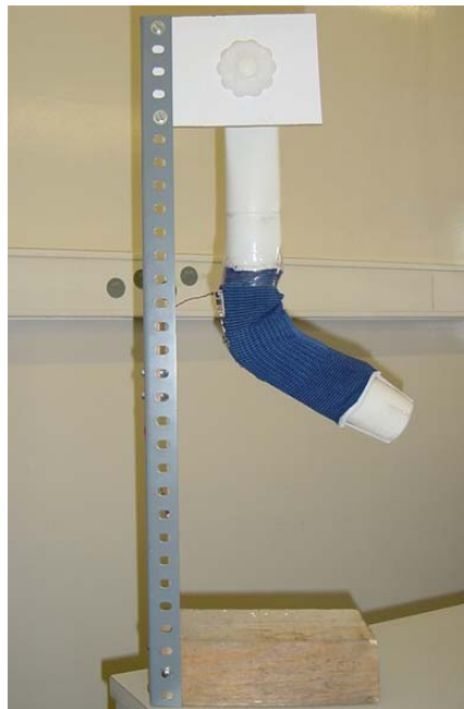
Figura 5.3 - Estrutura de teste do Bend Sensor , utilizando braço de manequim e cotoveleira elástica.
