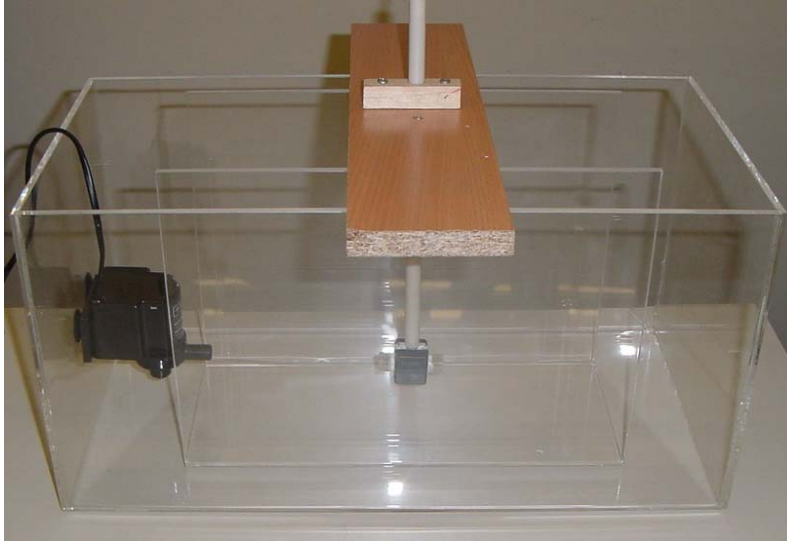
Figura 5.10 - Sistemas de testes do Flow Meter .
