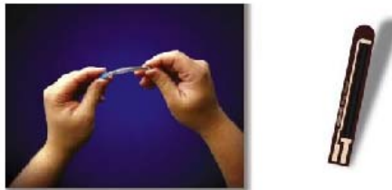
Figura 4.3 - Característica flexível do Bend Sensor .
