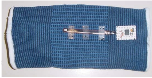
Figura 5.2 - Bend Sensor adaptado a uma cotoveleira.
