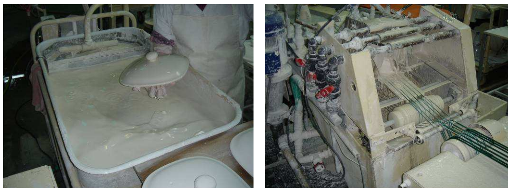
Figura 28 - Vidragem Manual e Automática
