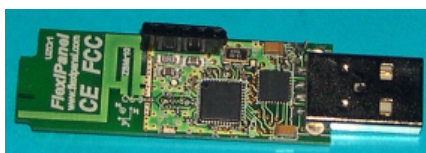
Figura 56 – Fotografia do interior do protótipo UZBee-Plus .
