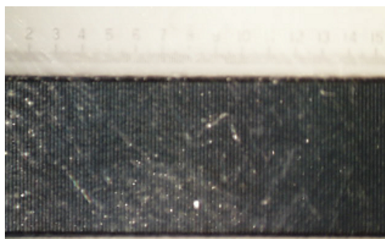
Figura 34 – Régua codificadora reflectora observada à lupa electrónica.
