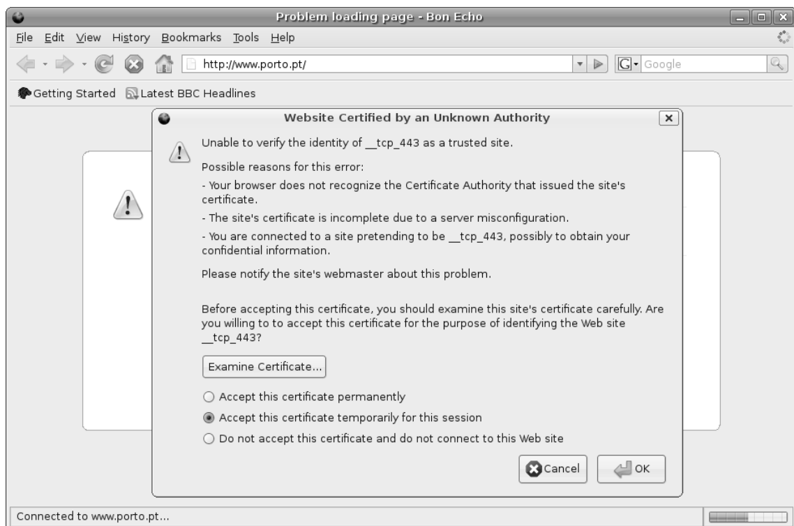
Figura 5.2: Exemplo de erro de validação com ScalSec no Firefox.
