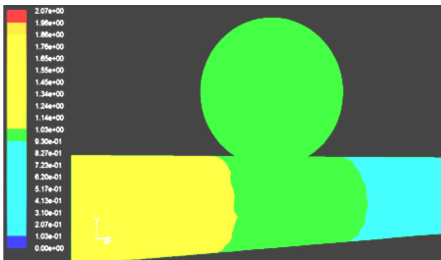
Figura 5.43- Pressão na parede do vaso sanguíneo e aneurisma. Escala representa a magnitude da pressão.
