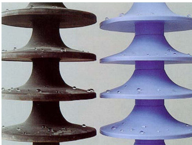
Figura 5.4 Hidrofobicidade de isoladores compósitos de borracha de silicone: isolador novo (direita) e isolador com camada significativa de poluição (esquerda) [11].
