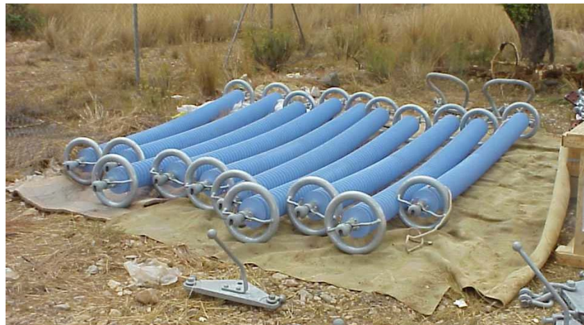
Figura 2.12 Conjunto de isoladores de compósito (fonte: REN).
