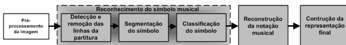
Figura 1.2: Estrutura típica de um OMR. Figura retirada de [2].
