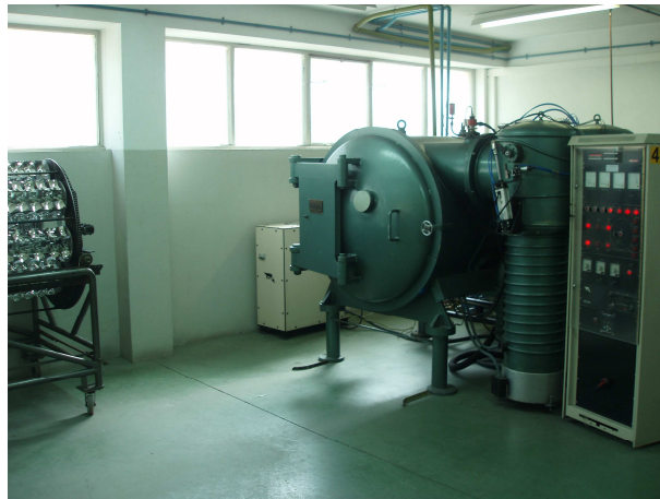
Figura 22 - Secção de Metalização
