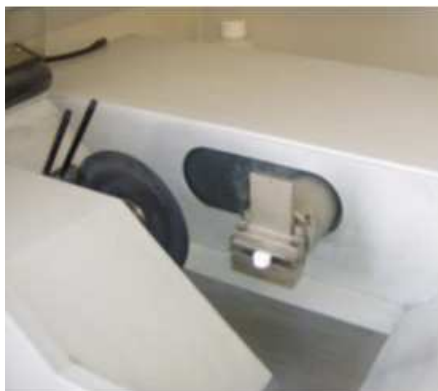
Figura 50 – Pastilha montada no porta-amostras (mordente) e este, por sua vez, montado na máquina.
