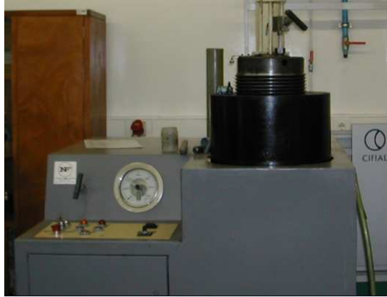
Figura 16 – Prensa isostática da National Force Europe.
