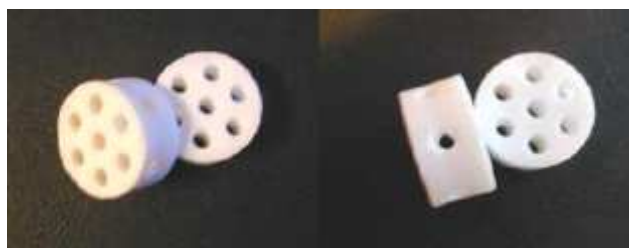
Figura 7 – Estruturas 3D em Bonelike® fabricadas num estudo prévio a este [11].
