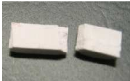
Figura 51 - Secções com pontas lascadas derivadas do corte. Peça do lado direito apresentou fracturas.
