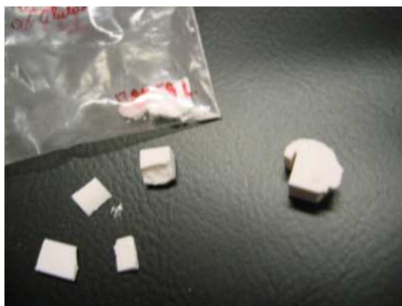
Figura 58 – amostras de 0% de celulose verdes cortadas pelos discos de alumina e diamantado.
