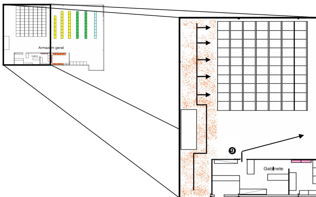
Figura 19 - Esquema representativo do “picking” das pequenas matérias primas depois da reestruturação do armazém
