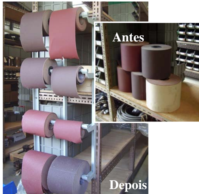
Figura 9 – Suporte para rolos de lixas antes e depois da reestruturação do AG
