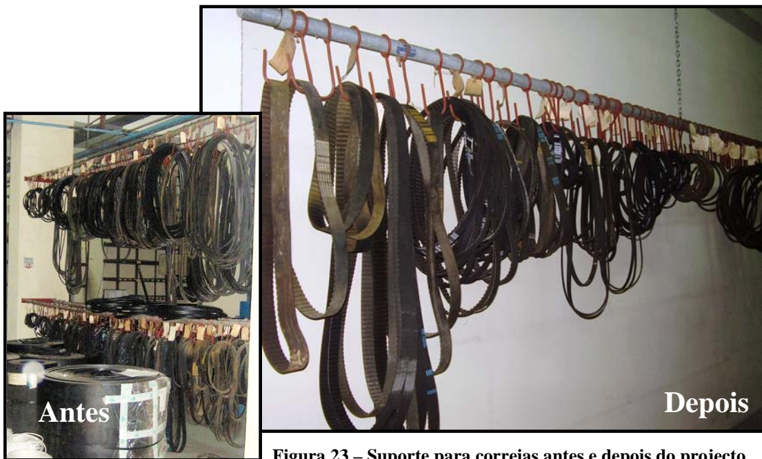
Figura 23 – Suporte para correias antes e depois do projecto
