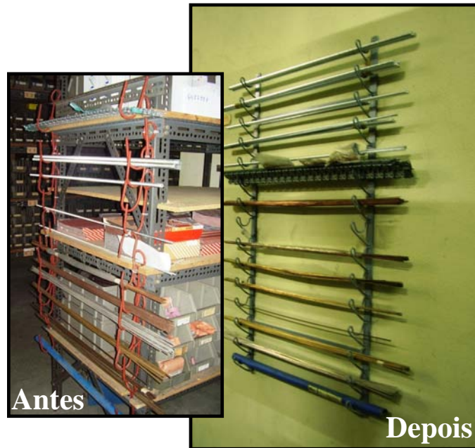
Figura 21 – Suporte para eléctrodos antes e depois do projecto
