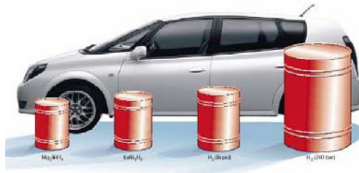
Figura 2 Volume ocupado por 4 kg de hidrogénio armazenado a 200 bar, como líquido, em hidretos metálicos ( Mg_2NiH_4 ; LaNi_5H_6 ), relativo ao tamanho do veículo.
