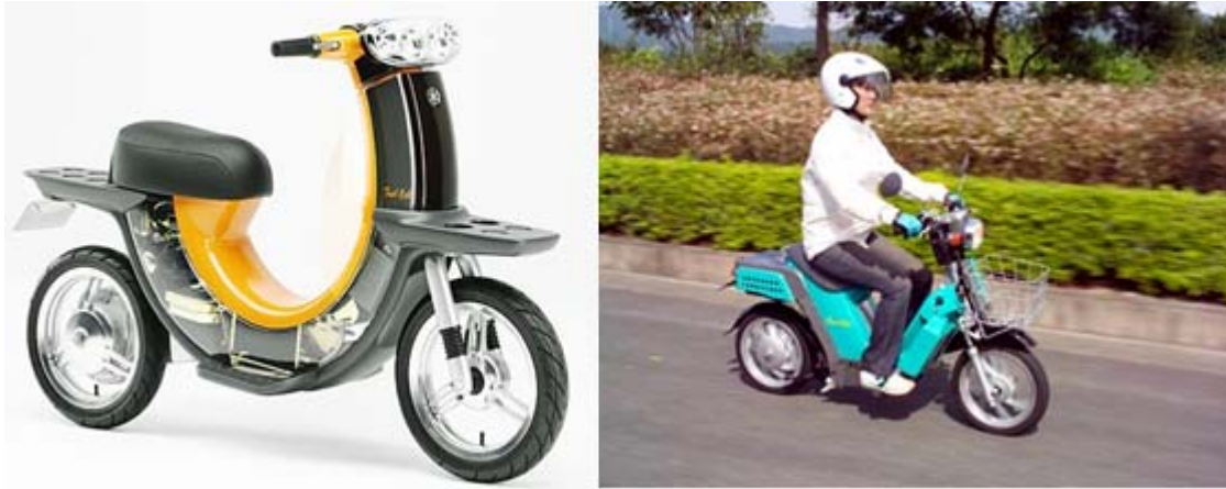
Figura 12 Scooter Yamaha "FC06 Proto" equipada com CCADM.
