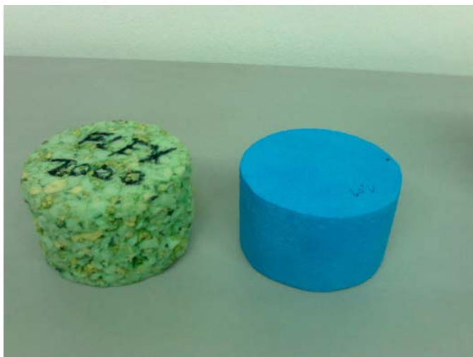
Fig. 3.3 –provetes de Aglomex Acoustic (esq.) e Aglomex Acoustic “pintado” (dir.) para uso no Tubo de Ondas Estacionarias.
