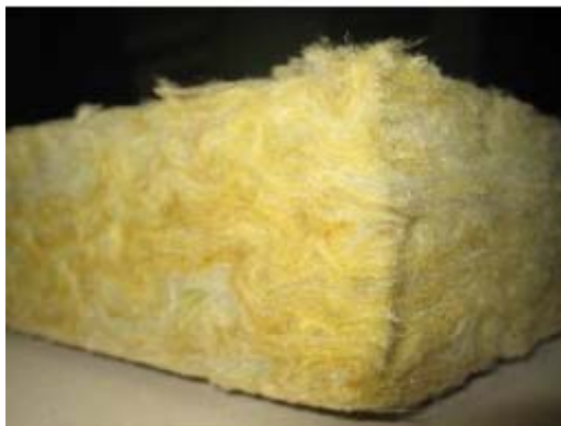
Fig 2.10 - Lã mineral fibrada.
