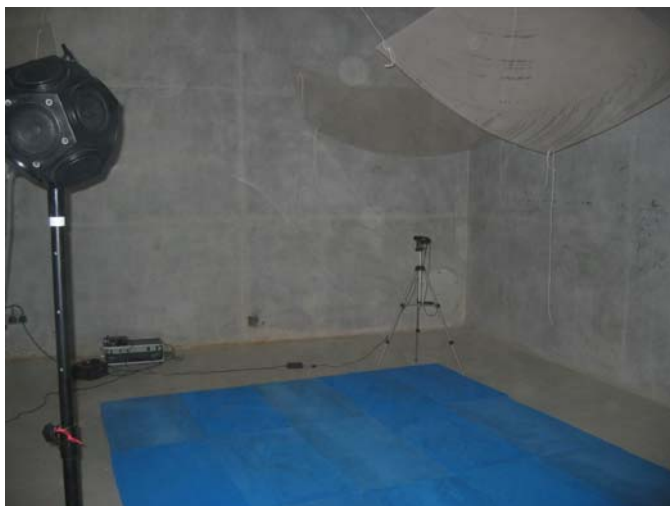
Fig. 5.33 – Foto do ensaio das espumas de Aglomex Acoustic “pintado” na Câmara Reverberante.
