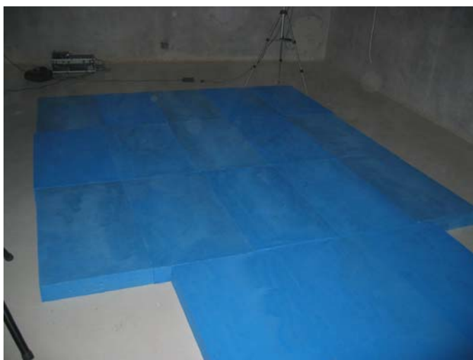
Fig. 5.32 – Foto do ensaio das espumas de Aglomex Acoustic "pintado" na Câmara Reverberante.
