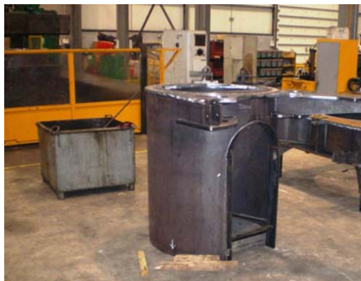
Figura 24: Tramo cabine após 1.ª fase pronta a ser maquinada
