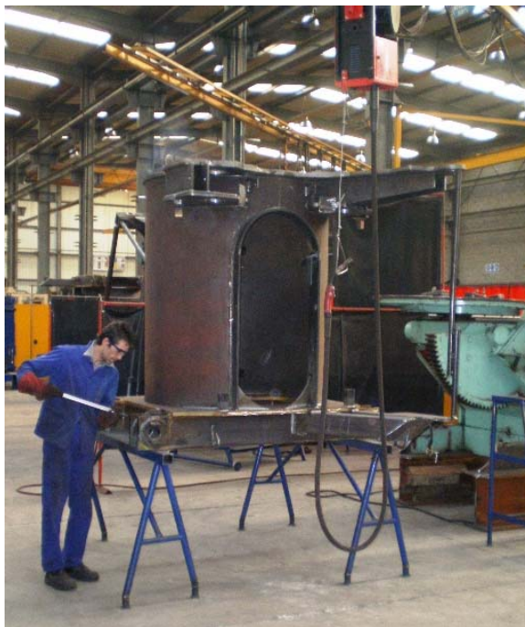
Figura 25: 2. a Fase de Soldadura de um tramo cabine
