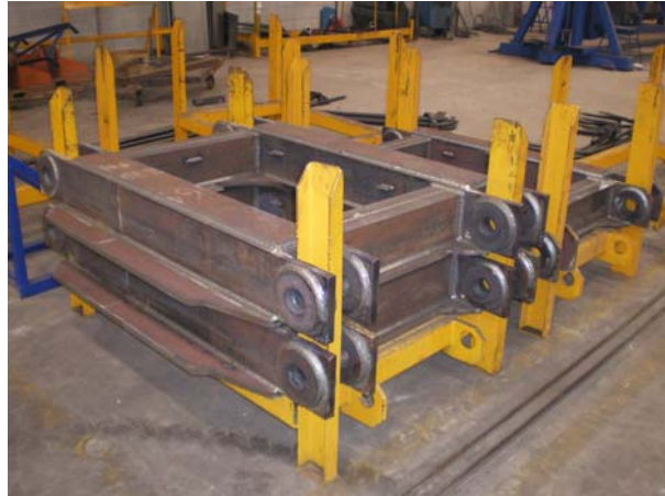
Figura 26: Parte superior do tramo cabine pós-1ª fase prontas a serem maquinadas
