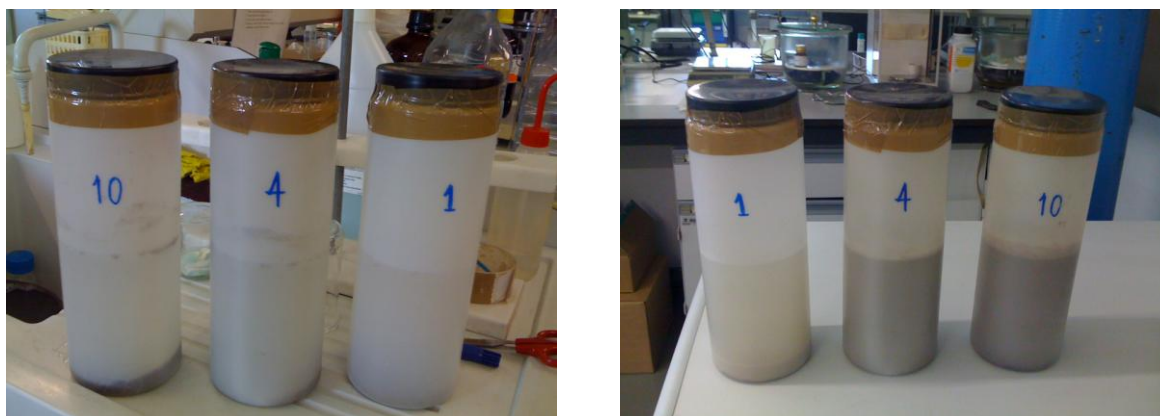
Figura 27 - Na figura da esquerda são apresentados os recipientes antes do ensaio de lixiviação e na figura da direita são apresentados os recipientes após o ensaio de lixiviação.
