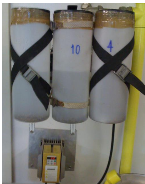
Figura 19 - Processo rotativo para obtenção do eluato.
