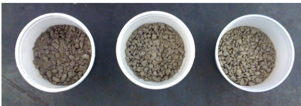
Figura 17 - Provette moído com tamanho inferior a 10 mm.
