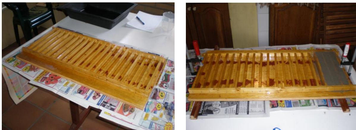
Figura 13 - Molde para colocação da mistura.
