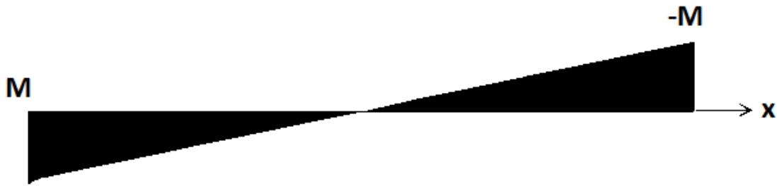
Figura 7. 6. – Diagrama de momentos flectores no elemento estrutural.
