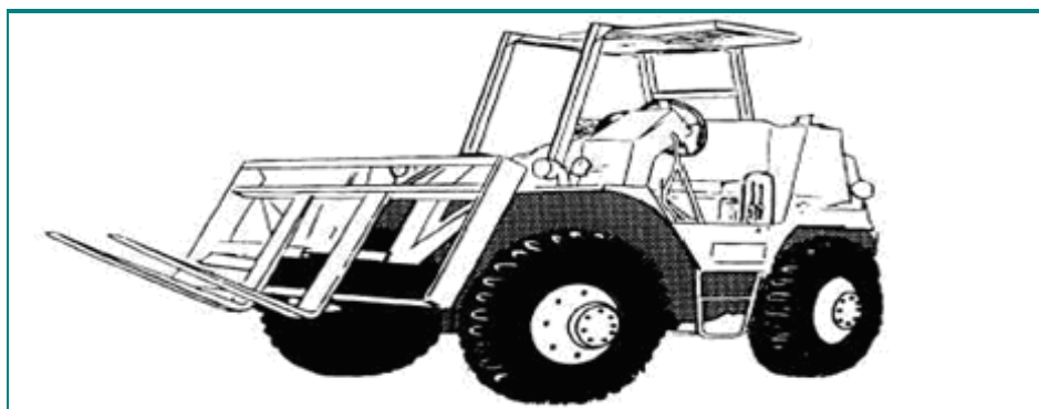
Fig. 43 – Empilhadora pesada para movimentação de contentores
