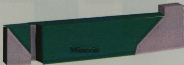
Figura 3 - Desmonte alargado para 12 metros e com metade da slot disparada.
