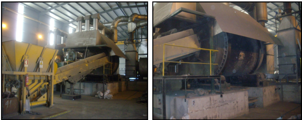
FIGURA 6 – Forno rotativo de 10 toneladas.
