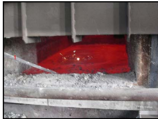
FIGURA 26 – Processo de desgasificação utilizado na empresa.
