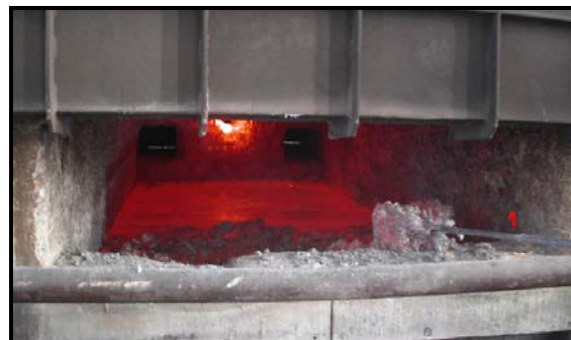
FIGURA 15 – Remoção da escória de afinação com a espátula (Skimmer)
