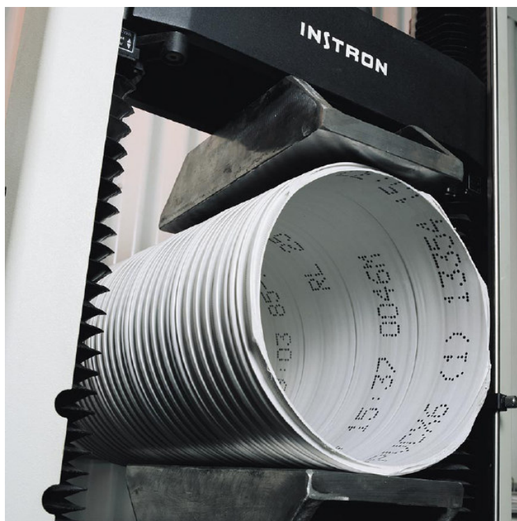
Fig. 6.3– Pormenor do ensaio de compressão do tubo “Expand” [24]
