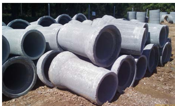
Fig. 3.9 – Tubos de betão DN500 – “Manilhas”
