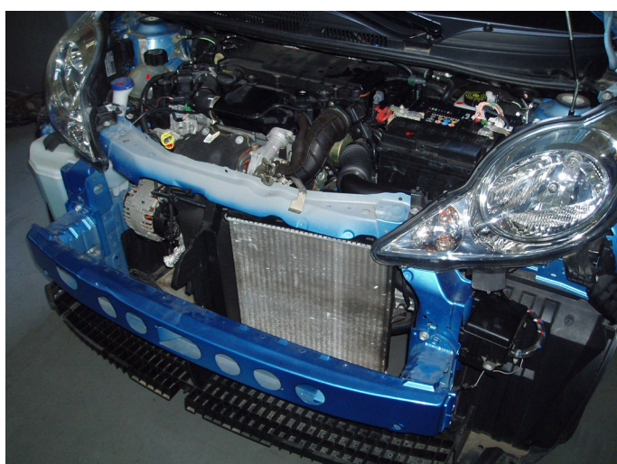
Figura 19 - Veículo utilizado nos ensaios realizados - Peugeot 107. Pára-choques frontal e capot removidos.
