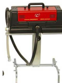
Figura 15 - Opacímetro Tecnotest usado nos ensaios
