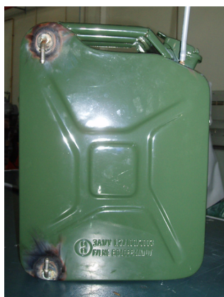
Figura 11 - Contentor usado como depósito de Biodiesel
