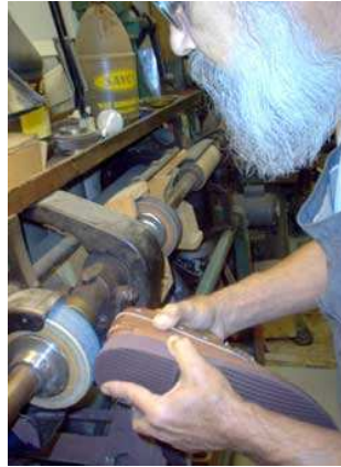
Figura 1.3 – Processo manual de acabamento por ferramenta abrasiva 2 .
