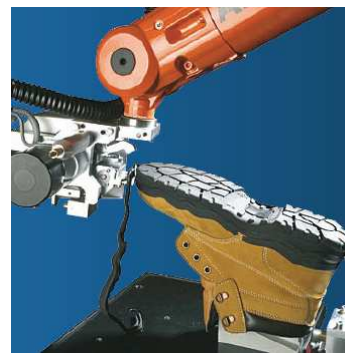
Figura 2.13 – Operação de corte de excessos de material (DESMA).
