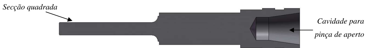
Figura 4.21 – Veio da ferramenta.
