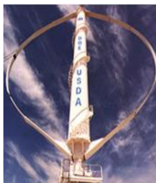
Figura 1.5 - Representação de um aerogerador de rotor com eixo vertical [8].
