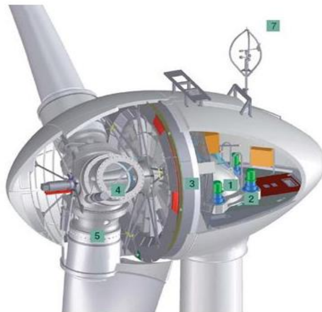
Figura 1.9 - Constituição de uma nacela de gerador multi-pólos [8].
