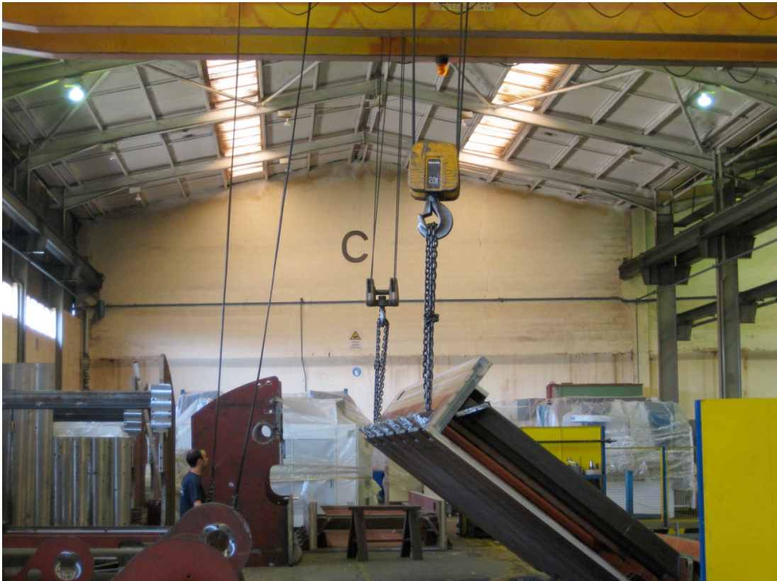
Figura 6.10 – Transporte de uma estrutura CCL – 4020 com mais de 15 toneladas de peso.
