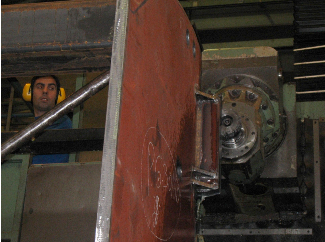
Figura 6.11 – Operação de desbaste numa estrutura de uma quinadora.
