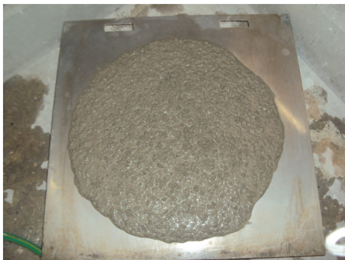
Fig. 3.8 – Ensaio de espalhamento de BAC com fibras plásticas
