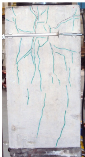
Fig. 5.19 – Diagrama força-deslocamento (transdutor interno e LVDTs externos); aspecto do prisma 6 de BACRF Xorex (sem armadura) no final do ensaio
