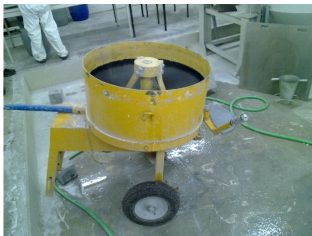
Fig. 3.21 – Betoneira utilizada para a produção das amassaduras.
