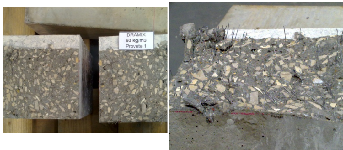
Fig. 4.26 – Aspecto dos prismas no final do ensaio para composição utilizando fibras da Dramix
