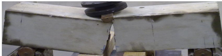
Fig. 4.17 – Diagrama força-flecha e fotografia da rotura para o BAC de referência
