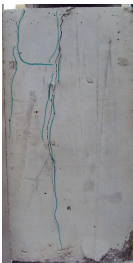
Fig. 5.18 – Diagrama força-deslocamento (transdutor interno e LVDTs externos); aspecto do prisma 5 de BACRF Xorex (sem armadura) no final do ensaio
