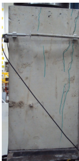
Fig. 5.17 – Diagrama força-deslocamento (transdutor interno e LVDTs externos); aspecto do prisma 4 de BACRF Xorex (com armadura) no final do ensaio
