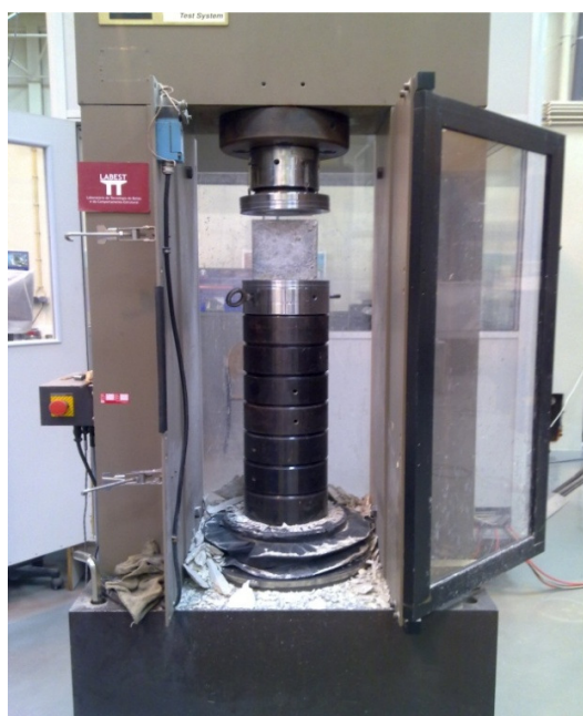
Fig. 4.2 – Equipamento utilizado para o ensaio à compressão
