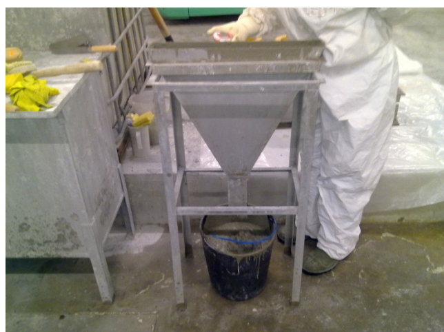
Fig. 3.13 – Ensaio do funil V, para o BAC sem fibras (composição de referência)
