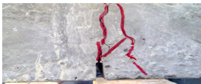
Fig. 4.19 – Diagrama força-flecha e fotografia da rotura para a composição com 40 kg/m 3 de fibras Dramix
