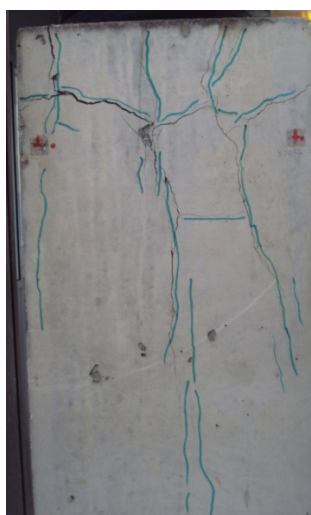
Fig. 5.16 – Diagrama força-deslocamento (transdutor interno e LVDTs externos); aspecto do prisma 3 de BACRF Xorex (com armadura) no final do ensaio
