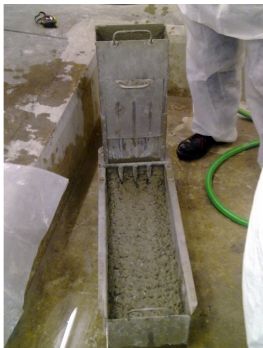
Fig. 3.11 – Ensaio da caixa L para o BAC de referência (sem fibras)
