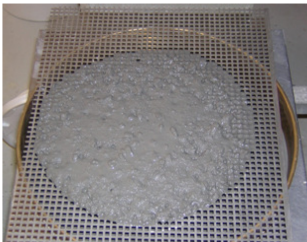
Fig. 3.14 – Ensaio da resistência à segregação
