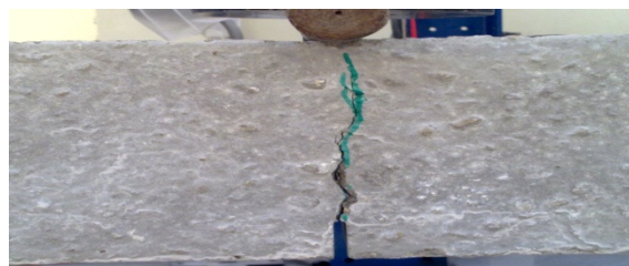
Fig. 4.22 – Diagrama força-flecha e fotografia da rotura para a composição com 40 kg/m 3 de fibras Xorex
