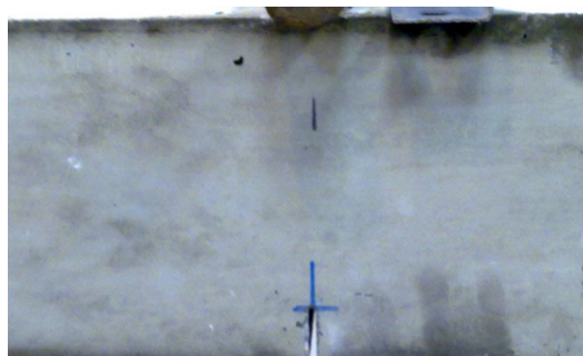
Fig. 4.4 – Pormenor do entalhe realizado nos provetes
