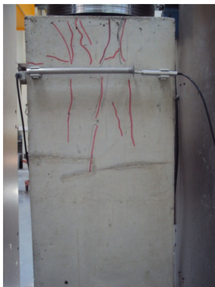
Fig. 5.15 – Diagrama força-deslocamento (transdutor interno e LVDTs externos); aspecto do prisma 2 de BACRF Dramix (com armadura) no final do ensaio
