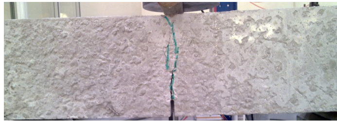
Fig. 4.21 – Diagrama força-flecha e fotografia da rotura para a composição com 30 kg/m 3 de fibras Xorex
