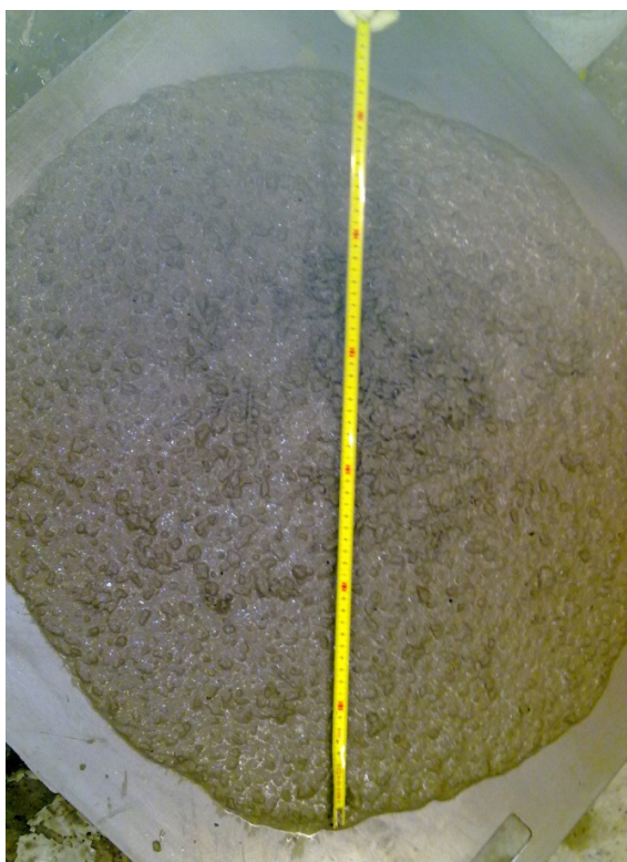
Fig. 3.25 – Ensaio de espalhamento para a composição com fibras Xorex ( 60\text{kg/m}^3 )
