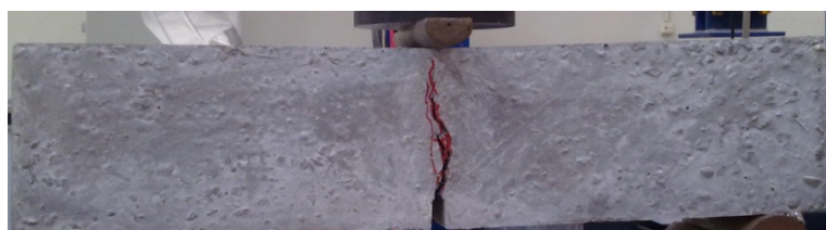
Fig. 4.20 – Diagrama força-flecha e fotografia da rotura para a composição com 60 kg/m 3 de fibras Dramix
