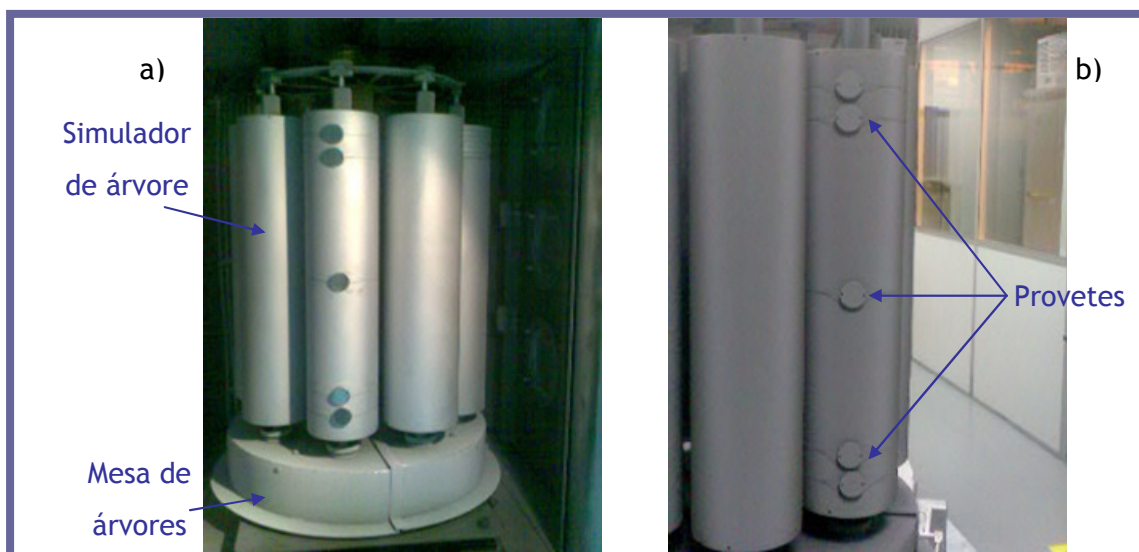
Figura 3.4 - Montagem dos provetes para teste a 140A de intensidade de corrente do arco eléctrico em todos os cátodos. a) Antes do teste, b) Após o teste.
