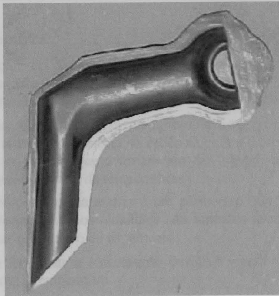
Figura 4.17 – Espigão forjado sem defeitos de enchimento
