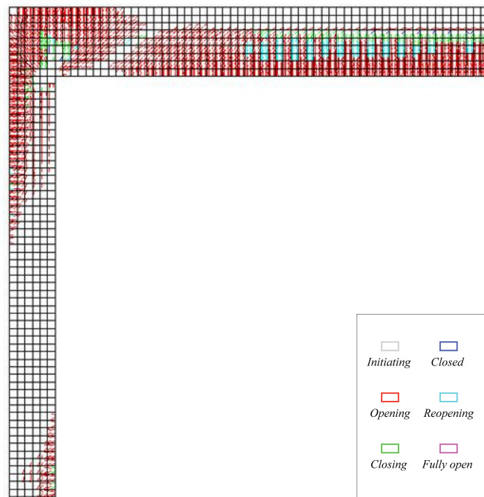
Fig. 6.26 - Padrão de fendilhacão de cálculo do pórtico 1 para o último incremento convergido
