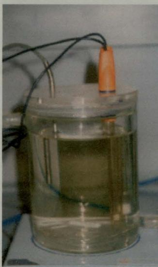
**Fig. 14 a)** - Cor apresentada pela mistura reaccional no interior do reactor *batch*, no início da experiência 2, antes da adição do  $H_2O_2$ .
