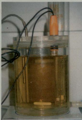
**Fig. 11 b)** - Cor apresentada pela mistura reaccional no interior do reactor *batch*, aos 15 min da experiência 1, após a adição de  $H_2O_2$ .
