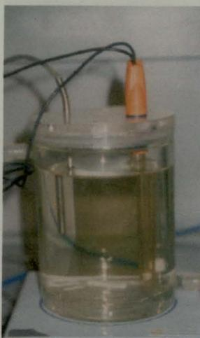
**Fig. 1 C** - Cor apresentada pela mistura reaccional no interior do reactor *batch*, no início da experiência 2, antes da adição do  $H_2O_2$ .
