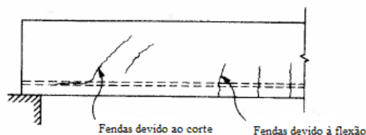
Fig.5 – Formação de fendas numa viga sujeita essencialmente a esforços de corte (Nilson, 1997)
