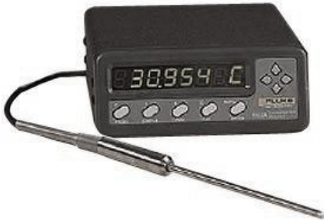
Figura 3.7 – Sensor padrão secundário de temperatura PRT (5608) e medidor digital (1502A).
