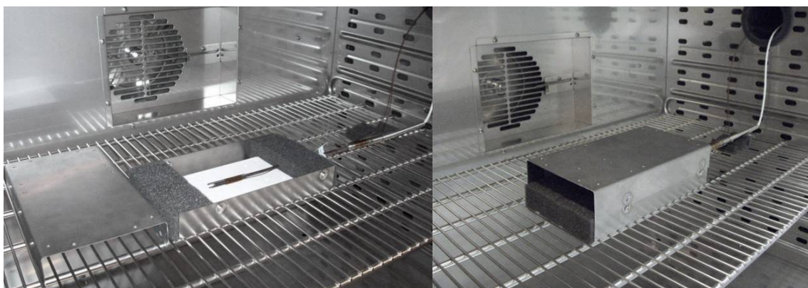
Figura 3.10 – Posicionamento do sensor padrão secundário de temperatura (5608) na câmara de ciclos térmicos e subestrutura para uniformizar a temperatura.
