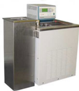
Figura 2.5 – Calibrador baseado em banho ( Bath Calibrator ).
