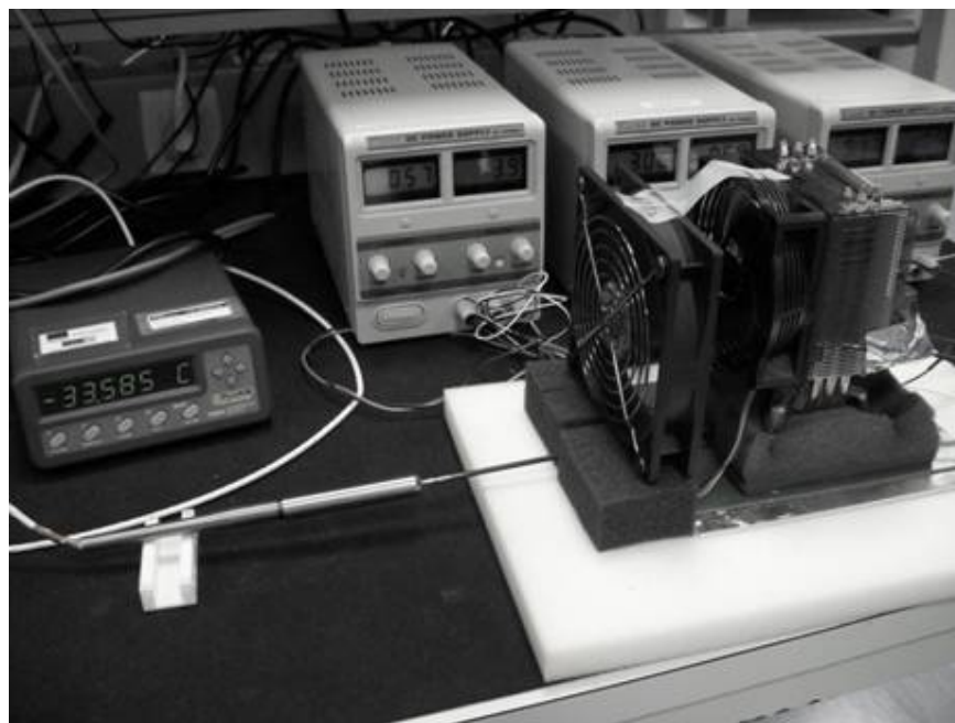
Figura 3.32 – Montagem ensaio 5: dois elementos Peltier com isolador para protecção térmica bloco alumínio e ventilador adicional.
