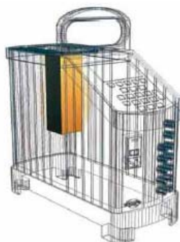
Figura 3.4 – Pormenor do bloco interior usado no calibrador Ametek.
