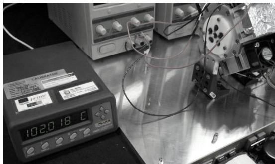
Figura 3.24 - Ensaio na aferição da temperatura máxima: protótipo nº1 do FSBlockCalibrator.
