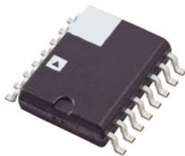
Figura 2.4 – Exemplo de sensor temperatura em Circuito Integrado.
