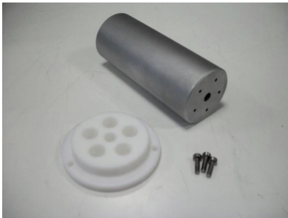
Figura 3.21 – Detalhe cilindro interno do sistema calibração FSBlockCalibrator protótipo nº1.
