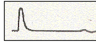
Figura 8.5 - Defeito numa caixa de derivação [2]
