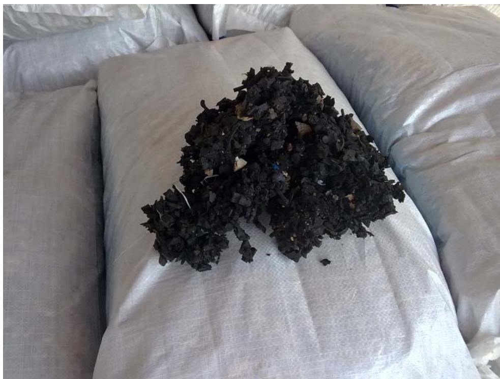
Figura 4.8 – Aglomerado de granulados de poliuretano e borracha
