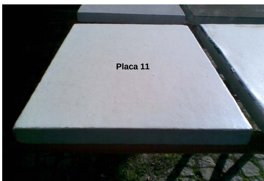
Fig. 5.36 – Placa com impermeabilização à base de poliuretano aplicado directamente na base
