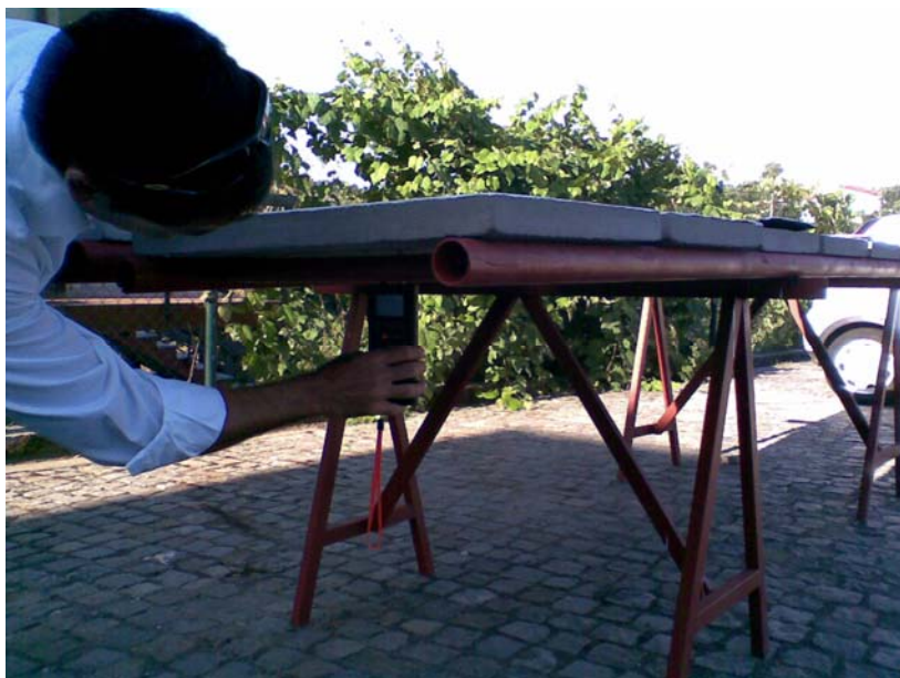
Fig. 5.10 – Modo de medição das placas (zona inferior)
