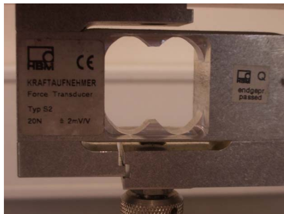
Figura 19 - Célula de carga até 20 N utilizada nos testes
