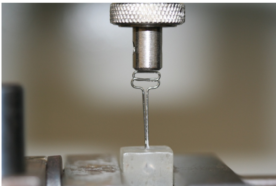
Figura 27 - Teste de compressão feito à mola T dupla onde se pode verificar a deformação induzida no corpo da mola pela carga axial.
