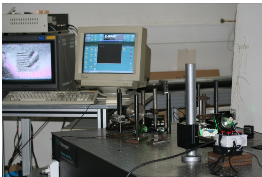
Figura 51 - Representação fotográfica do sistema de holografia-tv, zona de imagem e medição com iluminação a laser utilizado neste trabalho
