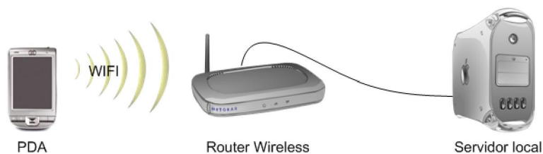
Figura 3.7 - Ligação do PDA por WIFI ao Servidor local
