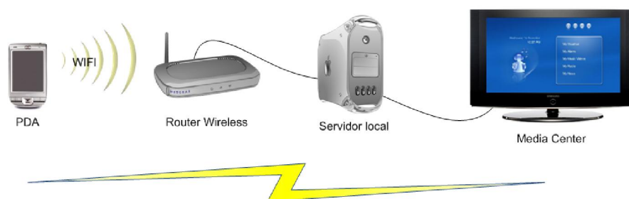
Figura 3.8 - Ligação do PDA ao Servidor local por socket via WIFI
