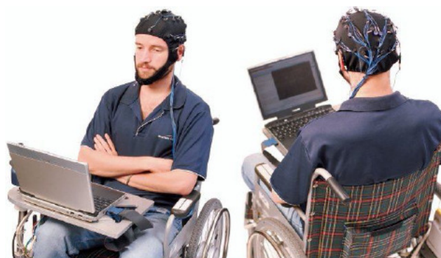
Figura 3.6 - Cadeira comandada por interpretação de impulsos mentais (adaptado de [14])
