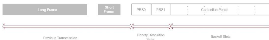
Figura 2.3 - Esquema do “Priority Resolution” e mecanismo de “Backoff” [10].
