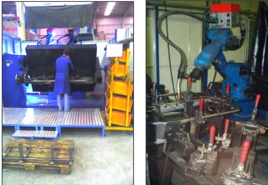
Figura 6 – Posto de trabalho da soldadura robotizada
