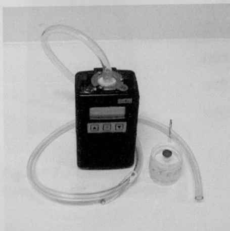
Fig. n.º 5 – Bomba de Aspiração com filtro de membrana em PVC
