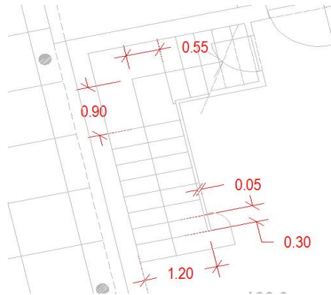
Fig. 5.13 – Características das escadas do corpo A
