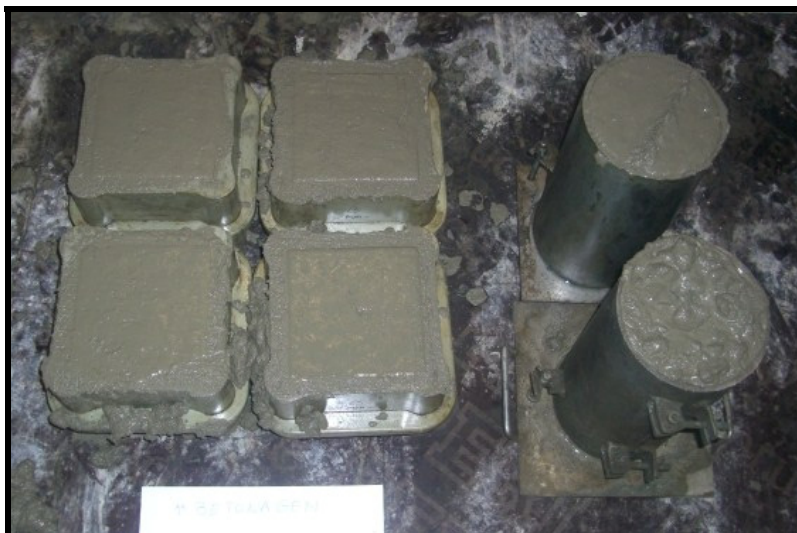
Fig. 17 – Moldes com betão fresco da primeira amassadura
