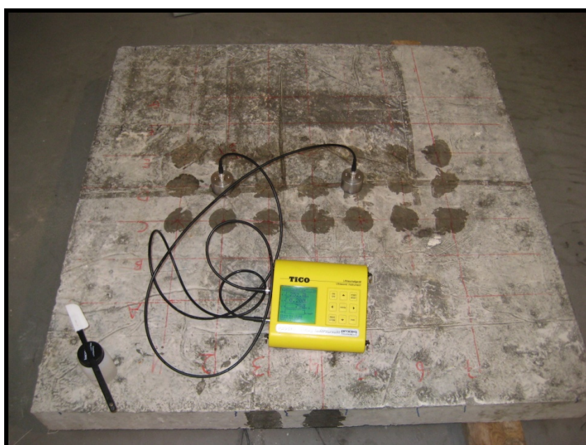
Fig. 35 – Ensaio por transmissão indirecta antes da fissuração
