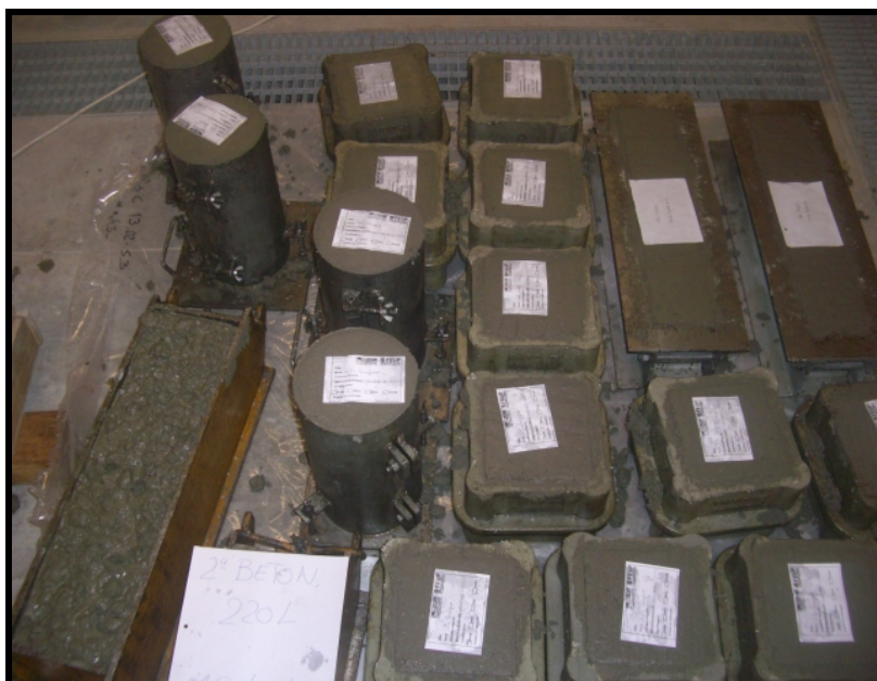
Fig. 19 – Moldes com betão fresco da segunda amassadura
