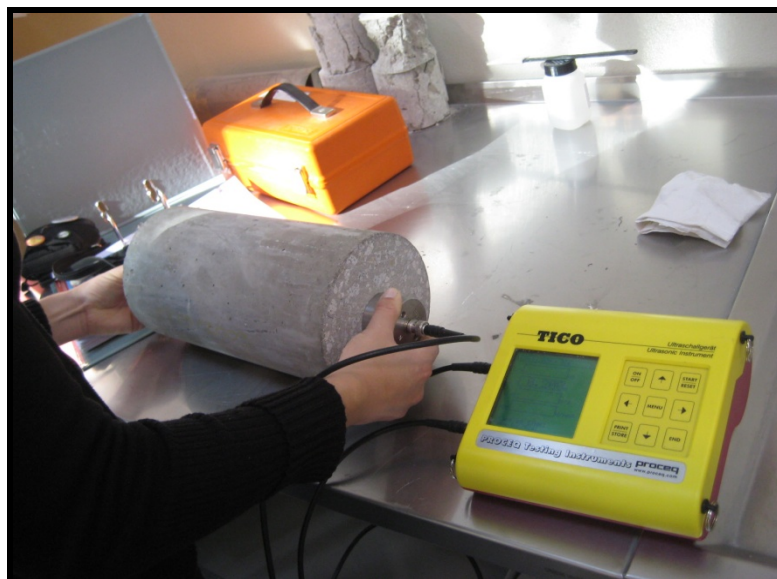
Fig. 4 – Ensaio de ultra-sons
