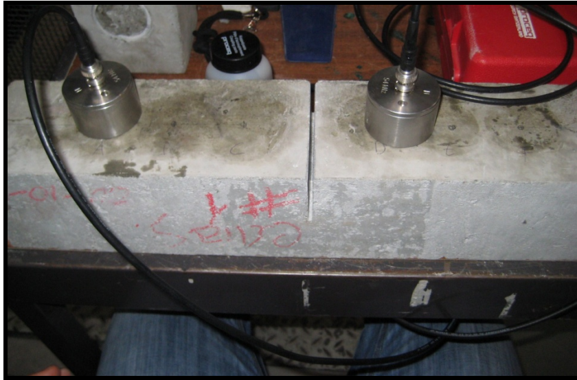
Fig. 32 – Ensaio de ultra-sons por transmissão indirecta em prisma fissurado
