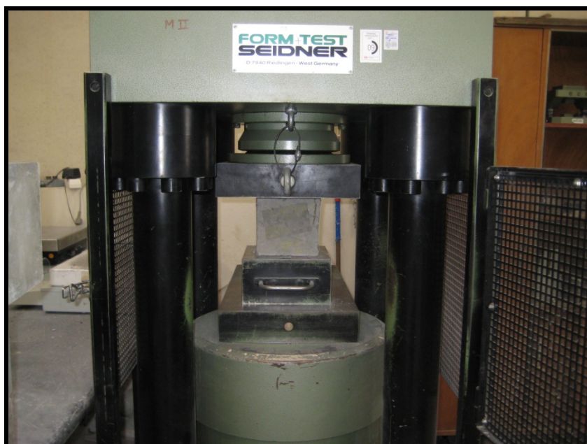
Fig. 27 – Ensaio de compressão de cubos
