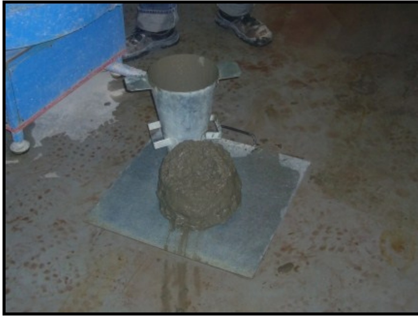
Fig. 16 – Ensaio de abaixamento da primeira amassadura
