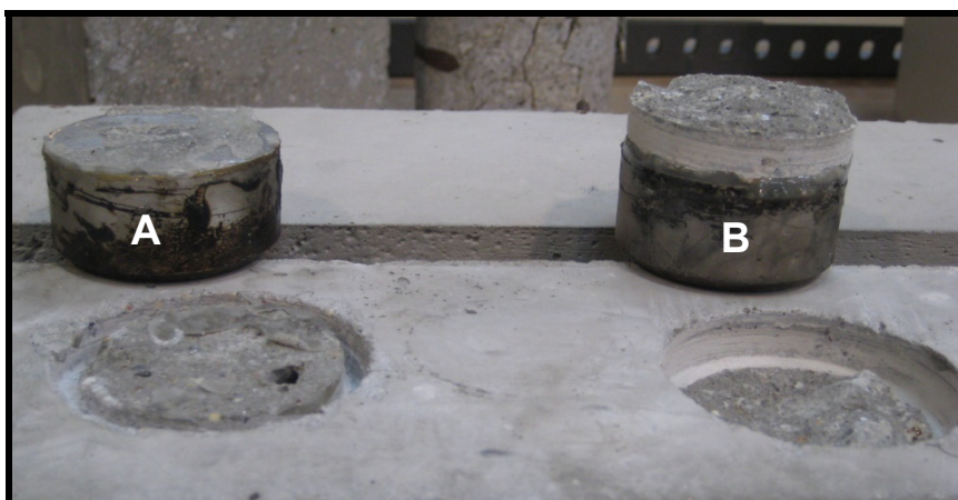
Fig. 41 – Pastilhas A e B e betão após arrancamento, ensaio de “pull-off” ao 32º dia
