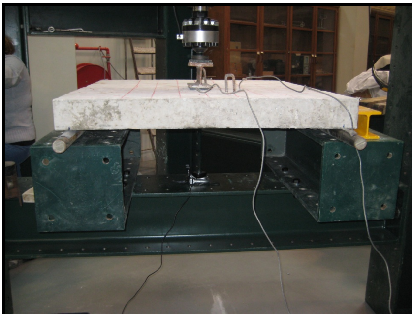
Fig. 36 – Carregamento da laje
