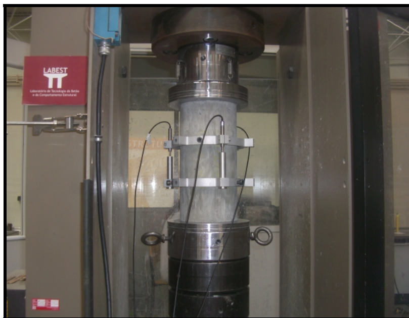
Fig. 31 – Ensaio do módulo de elasticidade em compressão
