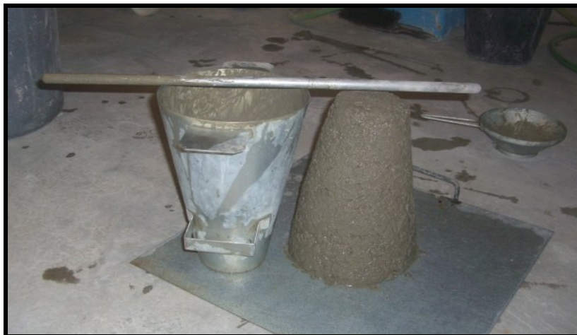
Fig. 18 – Ensaio de abaixamento da segunda amassadura
