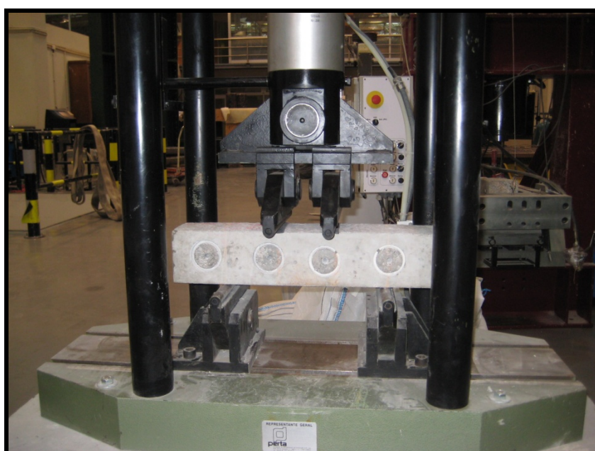
Fig. 28 – Ensaio de flexão de prismas
