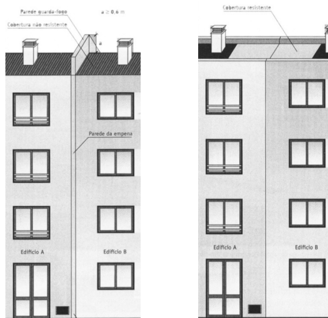
Fig. 2.6 e 2.7 – Compartimentação de edifícios adjacentes com a mesma altura (com parede guarda fogo e com cobertura resistente, respectivamente) [5]
