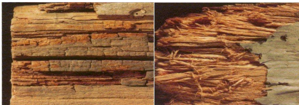
Fig 3.14 e 3.15 - Aspecto da madeira atacada por fungos da podridão (geral e pormenor, respectivamente) [19]
