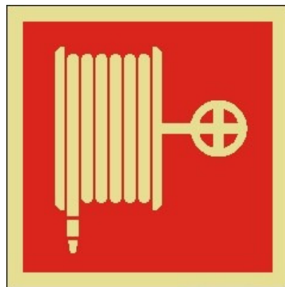
Fig.22 – Sinalização, boca-de-incêndio do tipo carretel [24]
