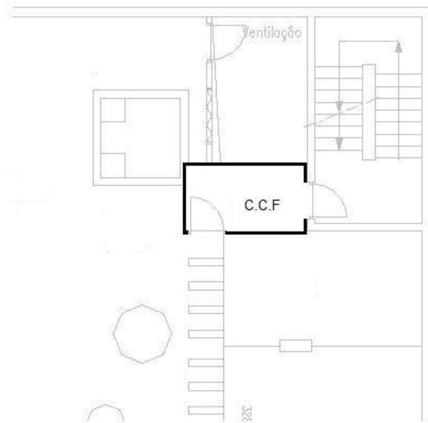
Fig.46 – Possível câmara corta-fogo, C.C.F.
