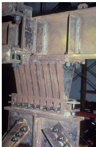
Figura 4.5. – Amortecedor metálico com placas de forma triangular [35]
