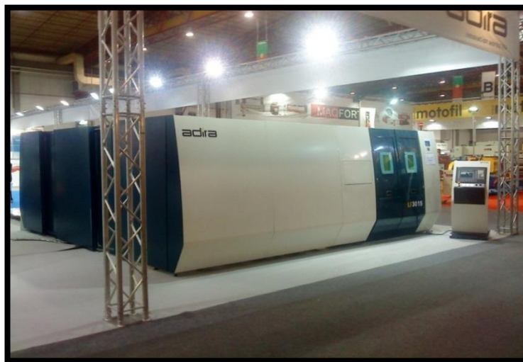
Figura 3.18) Centro de corte por laser LF 3015 da ADIRA. O sistema de troca de nozzle destina-se a equipar um centro de corte deste tipo.
