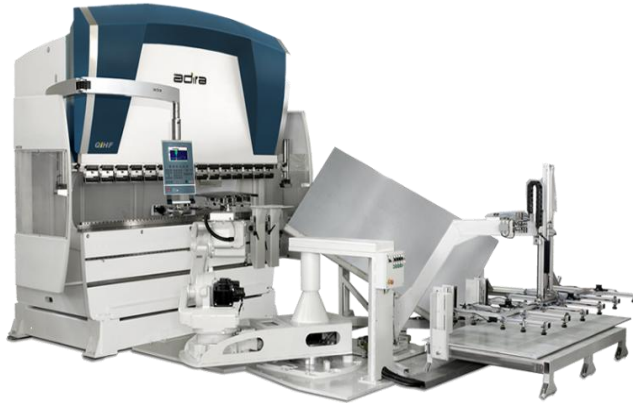
Figura 1.4) Quinadora do tipo QIHF, associada a um Sheet-Feeder e a um robot de manuseamento de chapa. Esta unidade dispensa operadores, pois é totalmente automática.
