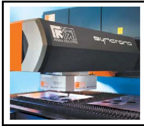
Figura 2.19) Cabeça de corte do modelo Sincrono da Prima. Neste modelo a cabeça move-se num eixo adicional em relação ao pórtico, atingindo acelerações de 6 G.
