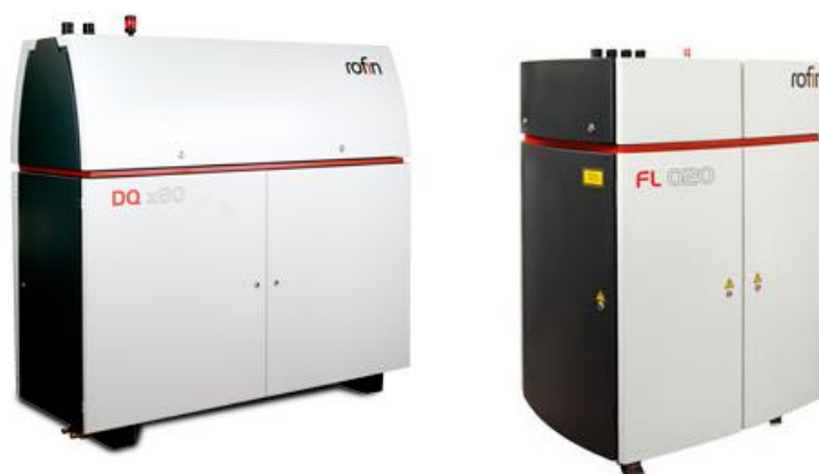
Figura 2.13) O gerador de Nd:YAG, à esquerda, apresenta dimensões muito superiores às do gerador de fibra, à direita na figura, tendo ainda de ser associado a um “chiller”. [6]
