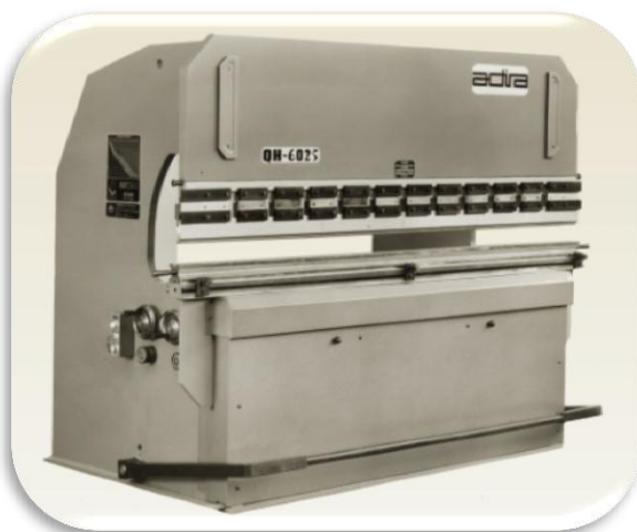
Figura 1.2) Quinadora hidráulica ascendente QH-6025, de inícios dos anos 60.
