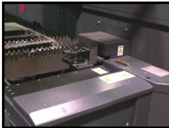
Figura 3.12) Gaveta de troca de nozzle desenvolvida pela Mitsubishi. Nesta fase a tampa que cobre os nozzles está fechada.
