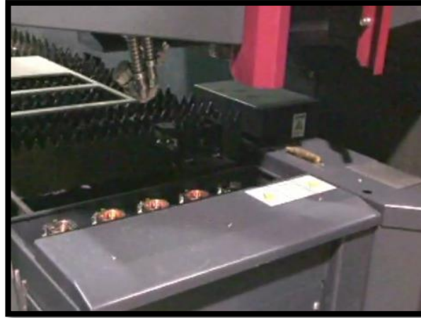
Figura 3.13) A tampa que cobre os nozzles abriu e a cabeça posiciona-se directamente acima do nozzle pretendido.
