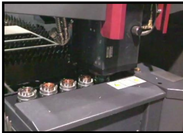
Figura 3.14) Os suportes dos nozzles movimentam-se na vertical de maneira a encostar o nozzle à cabeça. Em seguida todos os suportes começam a girar e a operação de aperto/desaperto começa.
