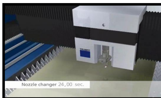
Figura 3.4) Final da operação de troca de nozzle. Nesta fase a gaveta já transladou para a posição de repouso, a mesa retornou à posição de trabalho e a cabeça prepara-se para iniciar o corte. O tempo total da operação foi de 24 segundos.
