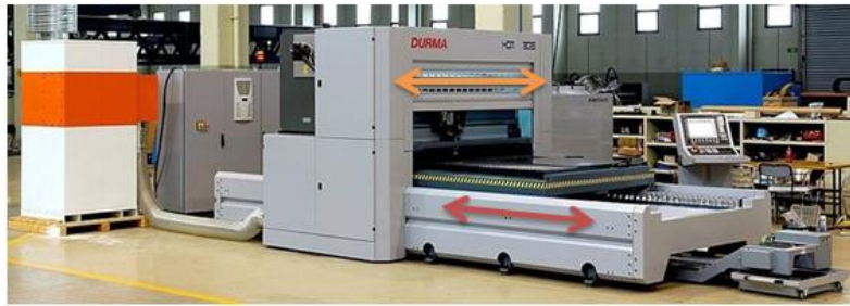
Figura 2.17) Máquina híbrida da Durma. A mesa desloca-se na direcção descrita pela seta vermelha, ao passo que a cabeça se move na perpendicular como exemplificado pela seta laranja.
