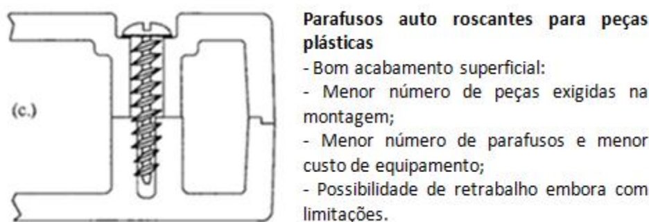
Figura 5 – Parafuso auto roscante (Baseado em Robert A. Malloy, 1992)
