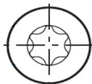
Figura 6 – Exemplo de fenda Torx (Catálogo Betzer)
