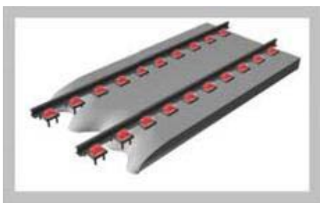
Fig. 33 Systèmes avec un seul point d'appui, ancrée dans un béton coulé in situ (workshop track for high speed railways, 2006)
