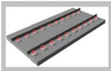
Fig. 32 Systèmes comprenant des éléments de dalle en béton préfabriqués (workshop track for high speed railways, 2006)
