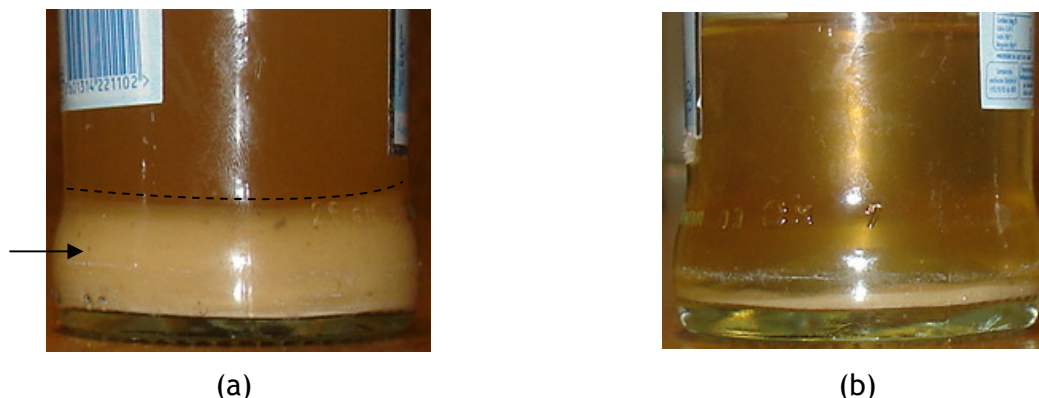
Figura 15 - Amostras retiradas pelo fundo do tanque de água arrasto a) imediatamente após abertura da válvula; b) alguns segundos depois de retirada a primeira amostra.
