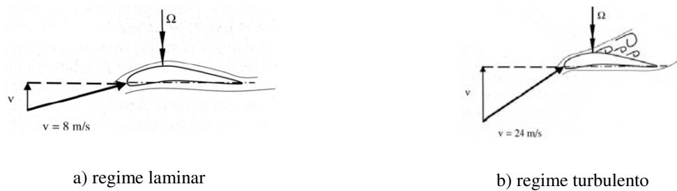
Figura 2-22 – Regime laminar e regime turbulento sobre o perfil de uma pá.
