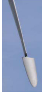
Figura 3-8 – Sistema de frenagem aerodinâmico, com rotação das pás em 85°.
